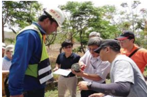
「屏東縣南二高橋下平面道路維護改善工程」實地鑽心取樣抽驗情形
