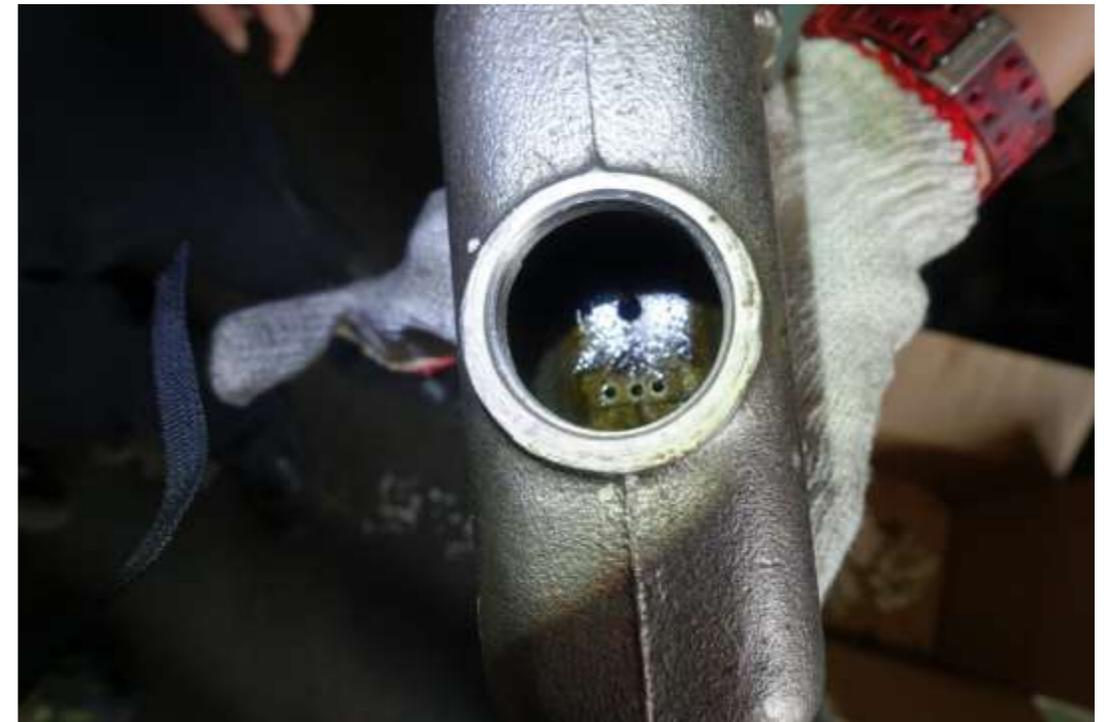
同型戰車煞車總泵上方油壺外觀
