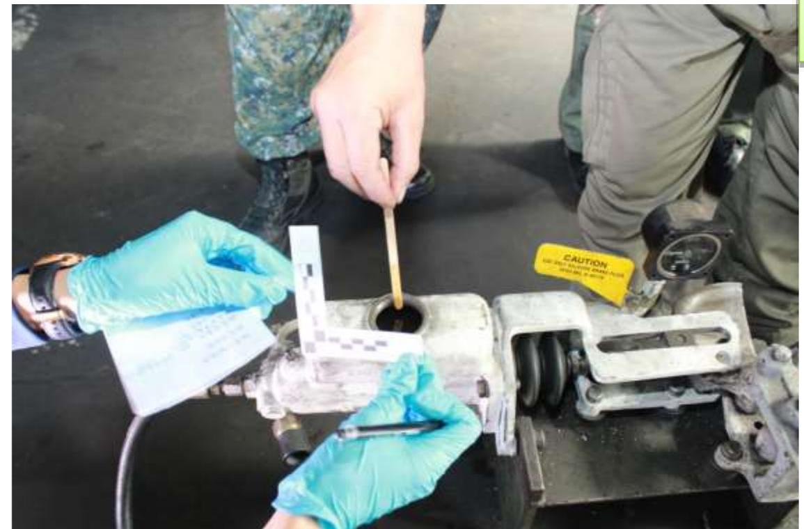
量測同型戰車煞車油壺內可裝填油量高度情形
