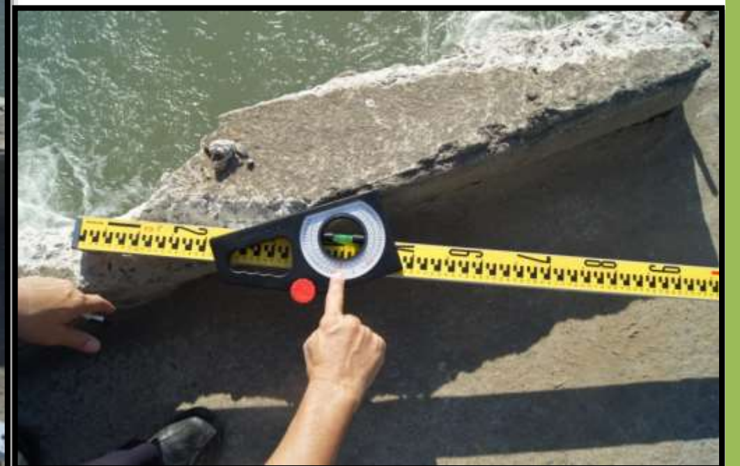
第一撞擊點（按即右側履帶最初駛上護欄之碰撞點），角度為 21 度，紅色箭頭為事故戰車行駛方向
